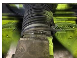
経年劣化で破損したアームカバー
