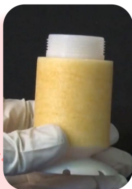
汚れたフィルタエレメント
