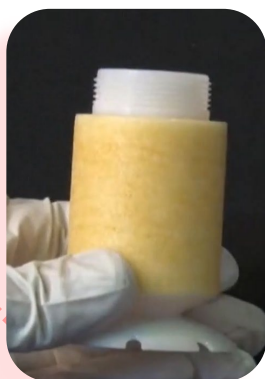
汚れたフィルタエレメント
